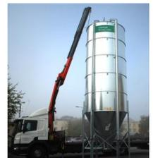
Serie Leiter mit Schutz, Einstieg oben mit Klappe versperrbar, Sichtfenster, Dach 30°, 160 mm Füllrohr, Auslauf auf 700 mm Höhe, Durchmesser 440 mm, mech. Schieber
